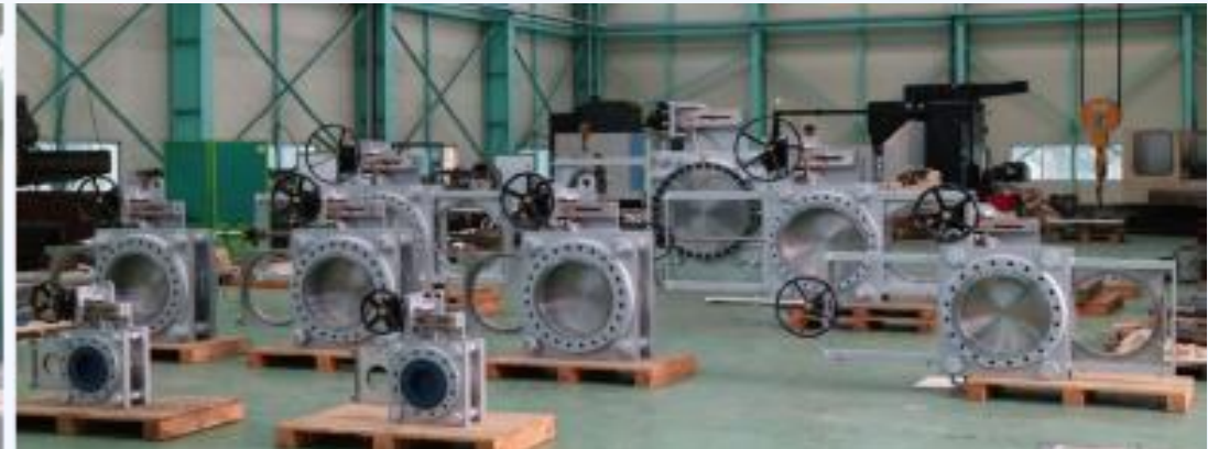
KACE的Y型三通球阀 (放料阀)
